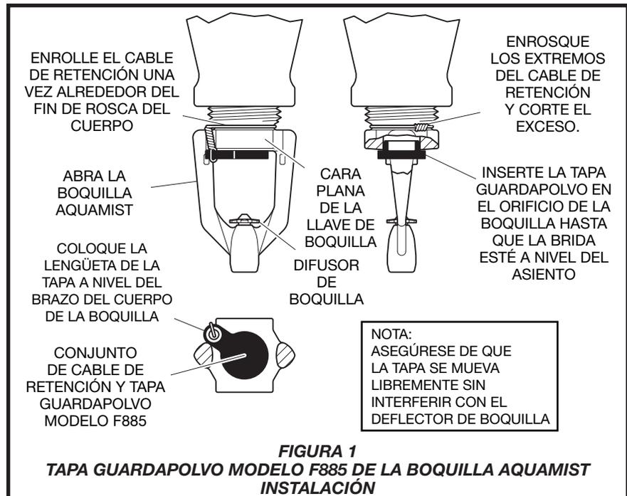
**Paso 3.** Enrolle el cable de retención alrededor del fin de rosca del cuerpo de la boquilla. Enrosque los extremos de los cables de retención y corte el exceso. Asegúrese de que la tapa se mueva libremente y no interfiera con el difusor de la boquilla.
